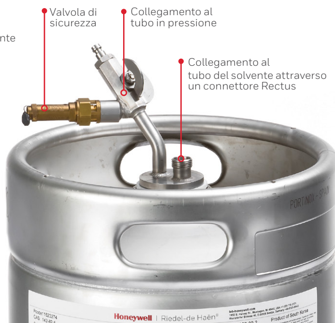
Rubinetto di dosaggio per contenitori privi di tubo pescante integrato
